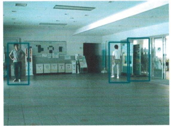
Fig.3.2 従来の HOG 特微量に基づく検出方法による誤検出例
