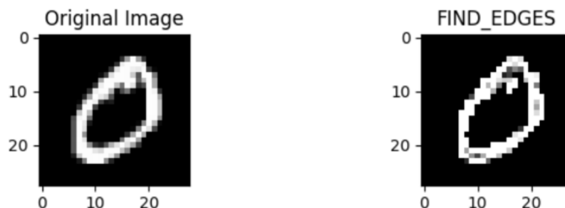
図5 画像の輪郭を抽出するためのフィルターを適用した後の画像 (輪郭抽出は画像から物体の境界線を検出する処理のこと)
