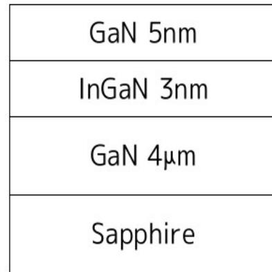
図3 実験試料 (InGaN/GaN系発光ダイオード)の構造 サファイヤ基板上に結晶成長させたGaN/InGaN/GaNの3層構造で、発光層はInGaN層(3nm)である。
